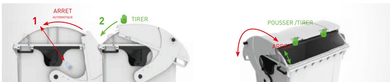
Des fixations supplémentaires des deux côtés de la bac roulant empêchent le couvercle bombé de se fermer automatiquement sous l'effet de son propre poids. Le couvercle ne se ferme pas totalement, laissant un espace libre d'au moins 181 mm. Le couvercle ne se ferme complètement que lorsqu'on le ferme manuellement.
