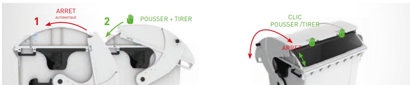
Le couvercle ne se ferme pas totalement, laissant un espace libre d'au moins 181 mm. Pour fermer complètement le couvercle, il est nécessaire d'actionner les boutons-poussoirs à deux mains tout en tirant le couvercle vers l'avant. Ces boutons sont fixés sur le bord avant du couvercle et peuvent être actionnés facilement avec le pouce, tout en tenant les poignées.
